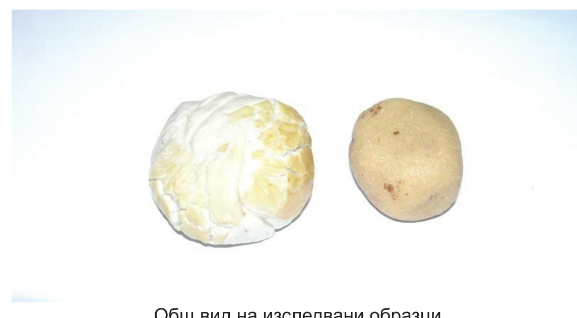
Общ вид на изследвани образци (пластилин в ляво и пластичен експлозив в дясно)
